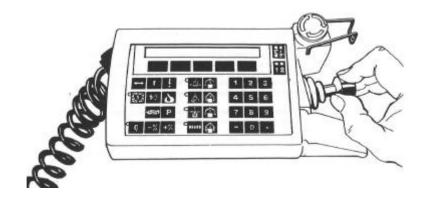
Mit dieser Konsole kann nicht nur der Roboter bewegt werden, sondern es können alle Funktionen des Roboters gesteuert werden. Man kann auch Programme über diese Einheit eingeben, diese auf Diskette abspeichern und ablaufen lassen. Natürlich ist diese Art der Programmierung sehr mühsam und mit einer Programmierung am Computer nicht vergleichbar.
